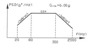
图1 随机振动验收试验条件
